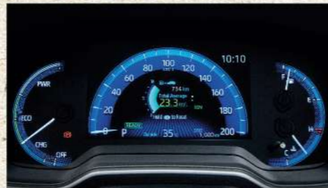
จอแสดงผลข้อมูลการขับขี่ MID (Multi Information Display) ขนาด 7 นิ้ว
