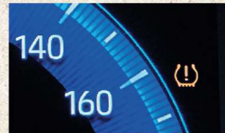
Tire Pressure Monitoring System ระบบแจ้งเตือนเมื่อลมยางผิดปกติ
