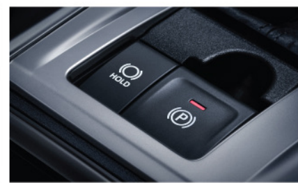
ระบบเบรกมือไฟฟ้า EPB และระบบหน่วงเบรกอัตโนมัติ ABH
