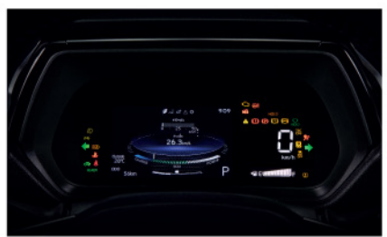
มาตรวัด Digital พร้อมจอแสดงข้อมูลการจับที่ TFT 7 นิ้ว
