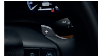
เป็นควบคุมการเปลี่ยนเกียร์ที่พวงมาลัย (Paddle Shift)
