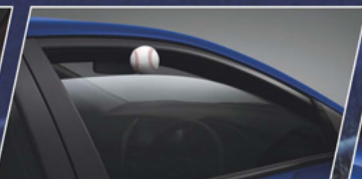
กระจกไฟฟ้าพร้อมระบบป้องกันการหนีบ ด้านคนขับ ปลดล็อกด้วยปุ่มกดที่พนักพิง เมื่อมีสิ่งกีดขวาง
