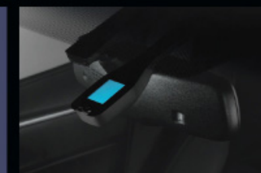
ระบบควบคุมการปิดน้ำฝนอัตโนมัติ (Rain Sensor) ทำงานอัตโนมัติทันที ที่เซ็นเซอร์ตรวจจับน้ำฝนได้ พร้อมปรับระดับความเร็วในการปิดให้สัมพันธ์กับปริมาณน้ำฝนในขณะนั้น
