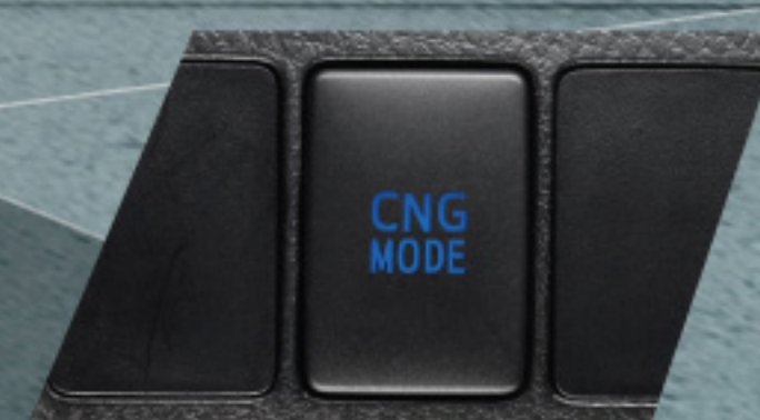
สวิตช์เลือกชนิดเชื้อเพลิง สามารถใช้ได้ทั้งระบบน้ำมันแก๊สโซฮอล์ E85 และก๊าซ CNG
