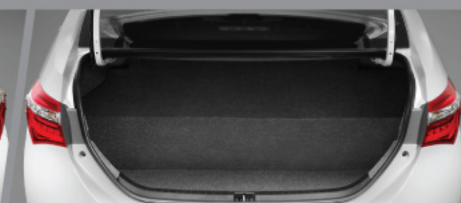
ปิดแผงกั้นถังก๊าซ
