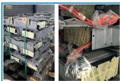
แบตเตอรี่ไฮบริด เตรียมพร้อมที่จะส่งให้ บริษัทขนส่ง โดยมีกร นำพลาสติกมาหุ้มสายไฟทั้งหมด เพื่อความปลอดภัย
