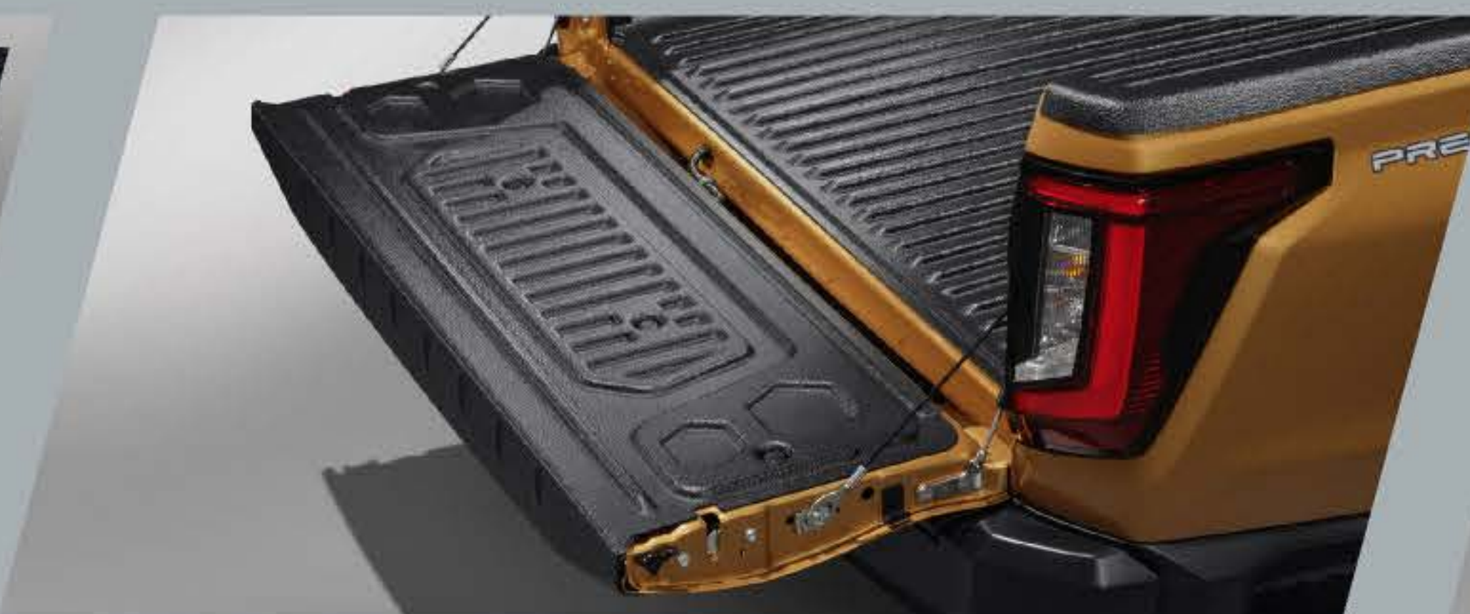
ใช้คช่วยผ่อนแรงเปิด-ปิดฝาท้ายกระบะ C,D-CAB
