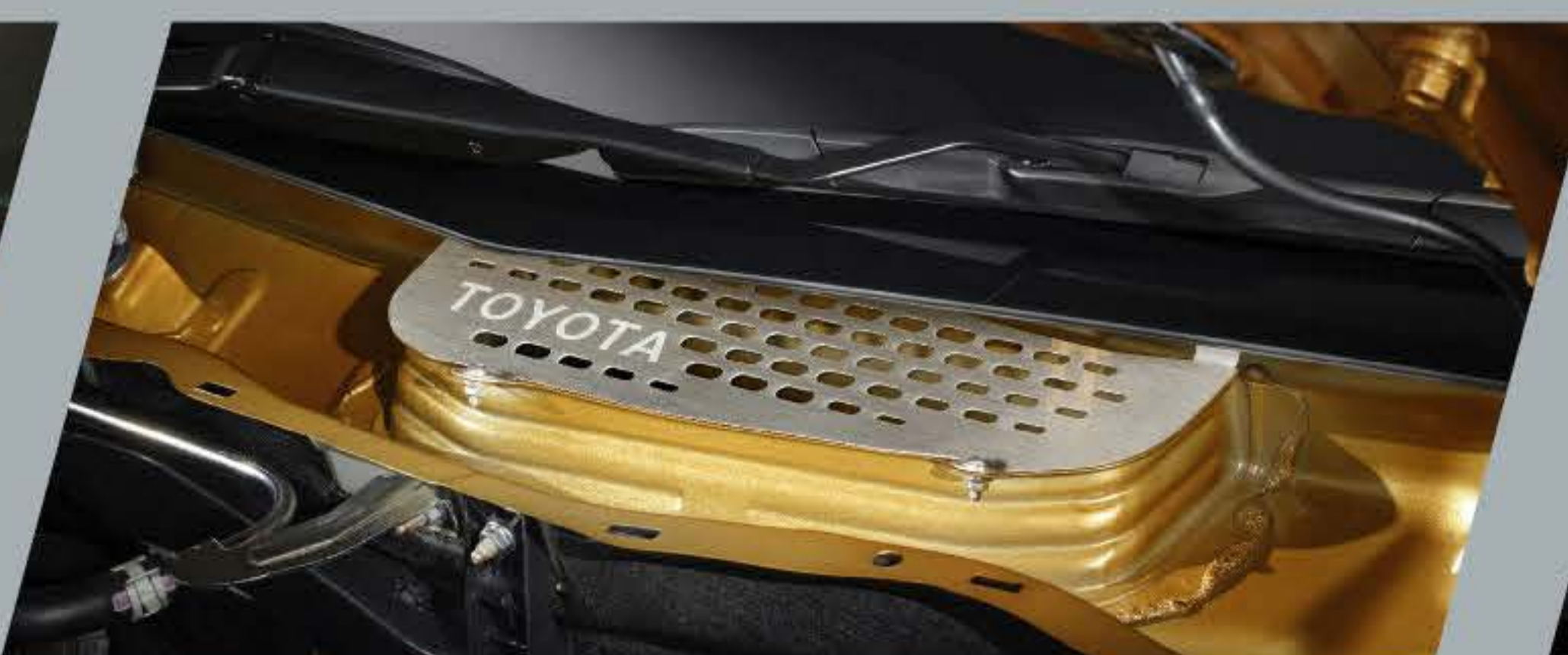
ตะแกรงสแตนเลสครอบช่องแอร์กันหนู
