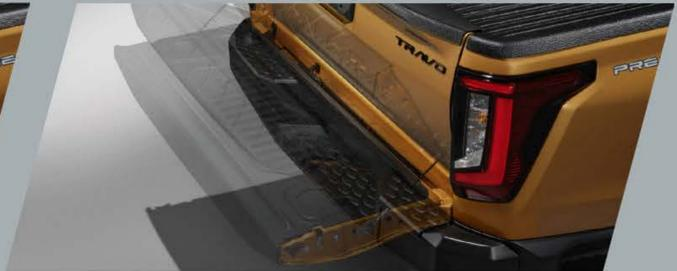
อุปกรณ์ผ่อนแรงเปิดฝาท้ายกระบะ C, D-CAB
