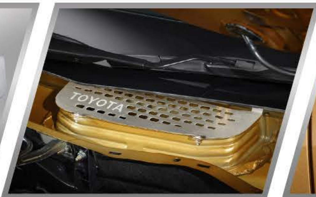
ตะแกรงสแตนเลสครอบช่องแอร์ กันหนู
