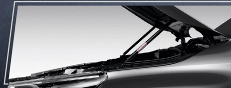
อุปกรณ์ช่วยผ่อนแรง เปิด-ปิดฝากระโปรงหน้า
