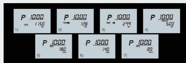
จอแสดงข้อมูลการขับขี่ MID (Multi Information Display) แสดงข้อมูลในการขับขี่ 1. ระยะทางรวม 2. Trip A 3. Trip B 4. ระยะที่ขับได้จากน้ำมัน ที่เหลืออยู่ 5. อัตราการใช้น้ำมันเฉลี่ย 6. อัตราการใช้น้ำมันในขณะนั้น 7. ความเร็วเฉลี่ย
